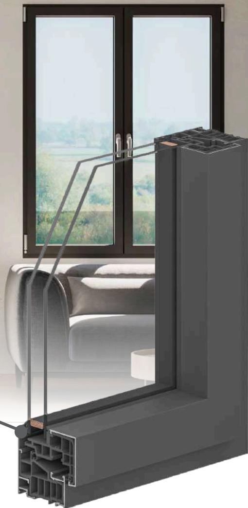
Perfiles de aluminio con alma de PVC. Triple junta con diseño en líneas rectas consiguiendo una rotura de puente térmico (RPT) mejorada.
